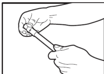
włożenie rury w złączkę aż do pojawienia się jej w otworze
